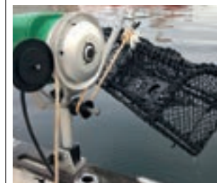
Teinehaling på aluminiumskive med to kilspor, kort bom og presshjul.
