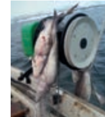
Fiskehjulet kan monteres både på aluminiumskive og garntrommel.
