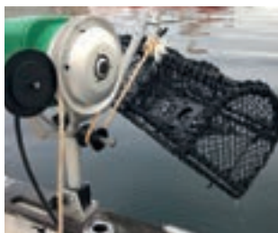
Teinehaling på aluminiumskive med til kilspor, kort bom og presshjul.
