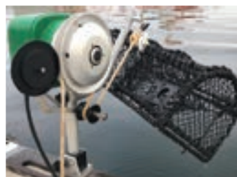
Teinehaling på aluminiumskive med to kilspor, kort bom og presshjul.
